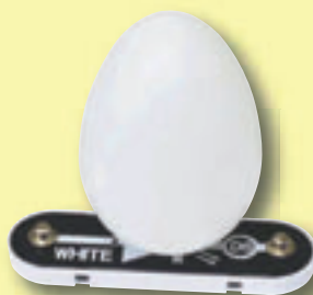
Jajko (dodatek LED) podłączony do D6
