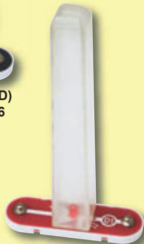
Wieża świetlna (dodatek LED) podłączony do D1
