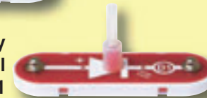
przezroczysty uchwyt na kabel podłączony do D1
